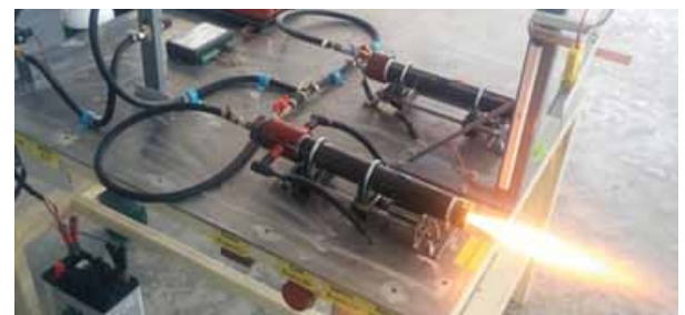
ภาพ 4 การทดสอบชุดต้นแบบจรวดเชื้อเพลิงผสมระบบหัวเทียน
