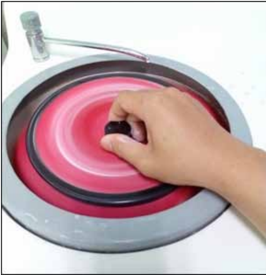
ภาพ 6 การขัดละเอียดบนผ้าสักหลาดโดยเติมด้วยผงอลูมินา
