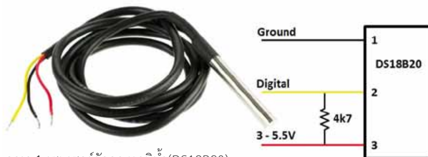
ภาพ 1 เซนเซอร์วัดอุณหภูมิน้ำ(DS18B20) ที่มา http://www.arduino.cc/products/21
