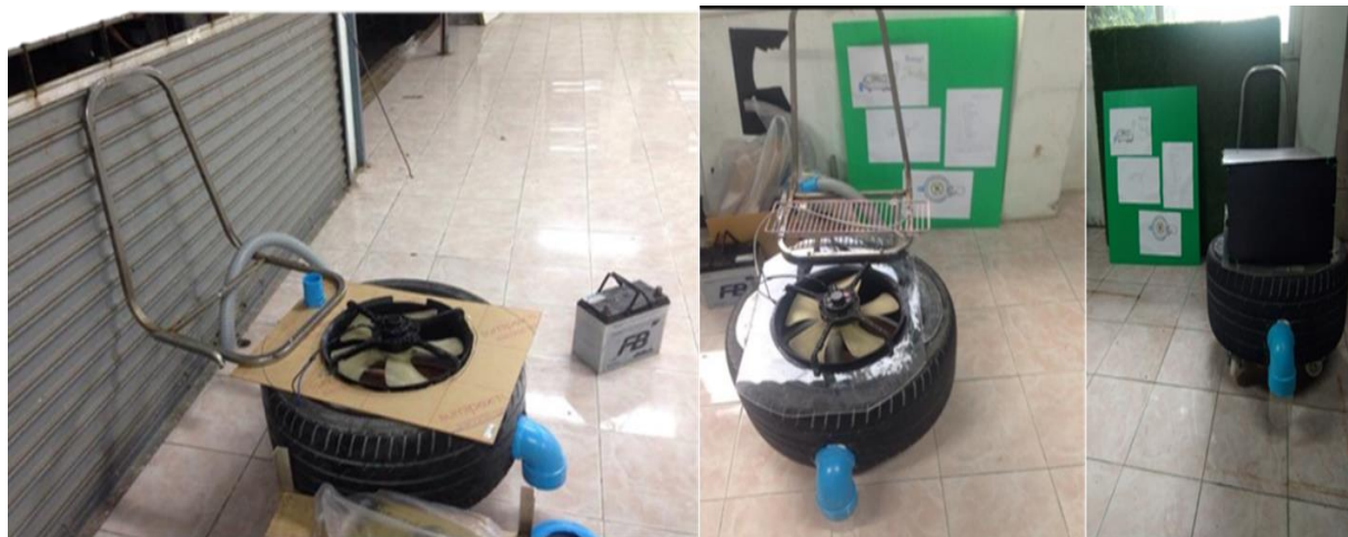
ภาพที่ 3 วัสดุ และการประกอบชิ้นงานเครื่องดูดและเป่าเศษหญ้าหลังการพัฒนาผลิตภัณฑ์
